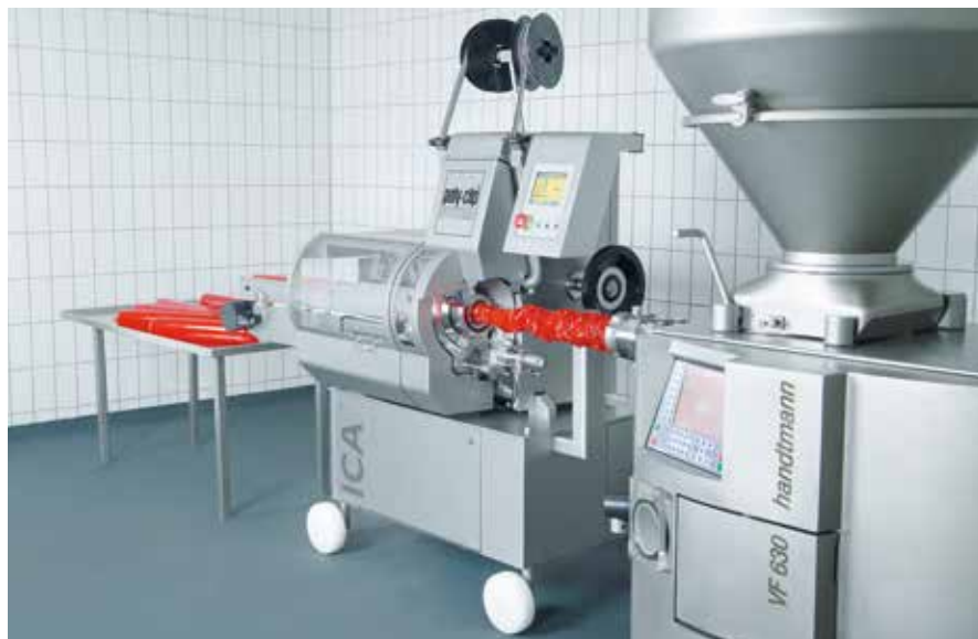
Ленточный транспортер ICA обеспечивает быструю выгрузку продукта. Устройство подпрессовки гарантирует отличную неплотную набивку
